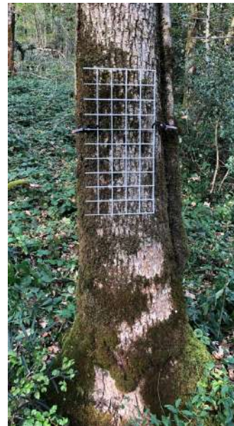
Figure n°5 - Dispositif allégé en forêt de Chailluz pour les bois moyens : grille sans châssis fixée par des tendeurs.
