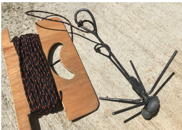
FIGURE 4 – Grappin utilisé pour les sondages et les prélèvements de plantes aquatiques.
