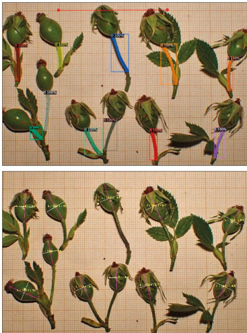
Figure 28 : mesures automatisées des dimensions des cynorhodons.
