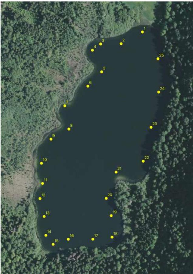
FIGURE N°2 - Localisation des transects. Les points de repères correspondent à l'extrémité du transect vers le centre du lac. Le transect est réalisé en parcourant la distance séparant le point de la rive selon un axe perpendiculaire à celle-ci.
