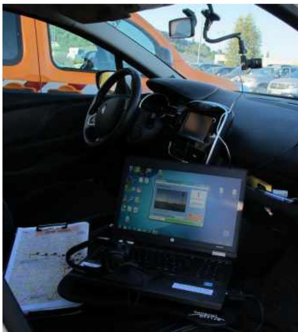
L'outil ISRI CAM de la DIR Est : une caméra et un gps reliés à un ordinateur portable, permettant à l'observateur (passager du véhicule) de saisir, de consigner, de géolocaliser et de photographier ses observations (M. Vuillemenot).
